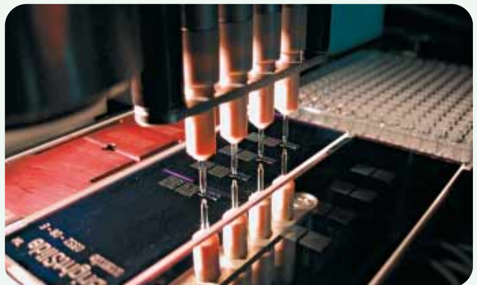
Abb. 2: Mikrochips, die zur Dekodierung von ESACHEL-Selektionen dienen, wurden von Dr. Jens Sobek am Functional Genomics Center Zürich (FGCZ) mit Hilfe von Spotting-Robotern hergestellt. (Foto: Dr. Jens Sobek, FGCZ)
